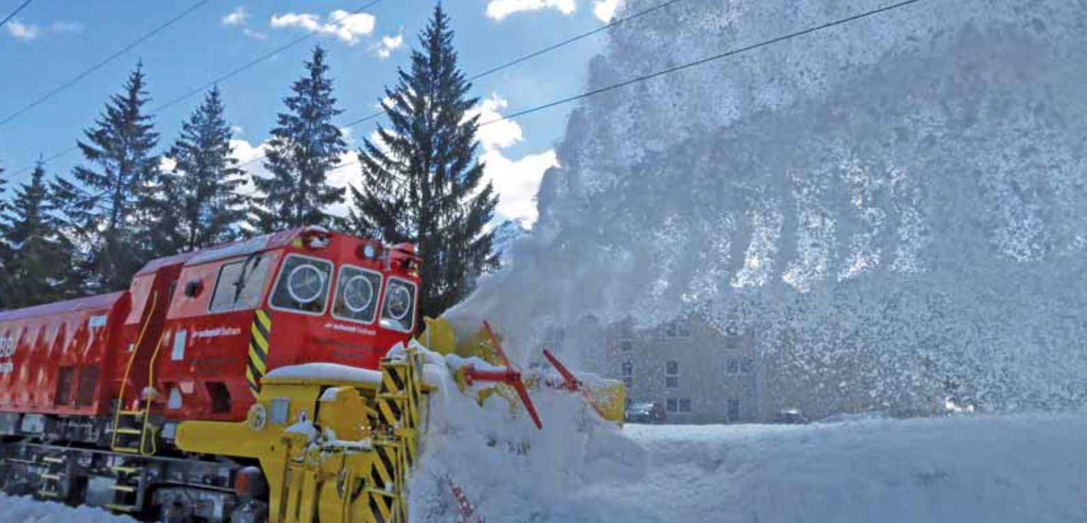
Mit der Schneeschleuder Schmidt Beilhack HB100S können selbst die schwierigen alpinen Wetterverhältnisse gemeistert werden.
