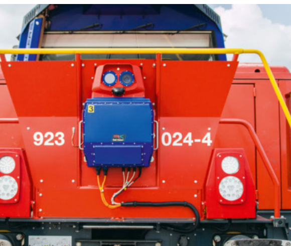
Auch das Kollisionswarngerät wurde neu entwickelt
