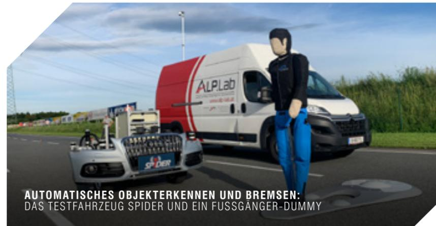
das Verhalten von Fahrzeugen auf Kollisionskurs mit Objekten testen. „Damit können wir eine geschlossene Testkette vom Sammeln der Daten über die Simulation bis zur Überprüfung in realer Umgebung bieten“, so Greiner.
