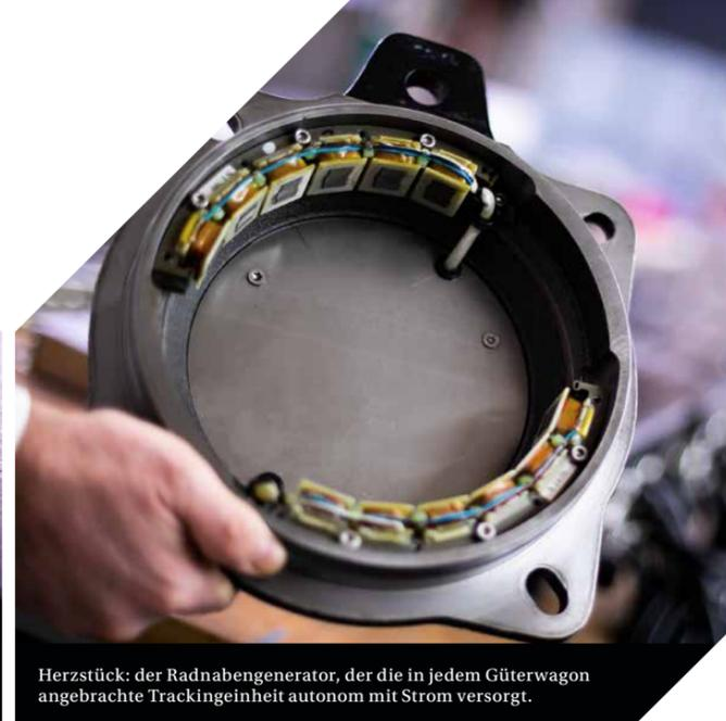
Herzstück: der Radnabengenerator, der die in jedem Güterwagon angebrachte Trackingeinheit autonom mit Strom versorgt.
