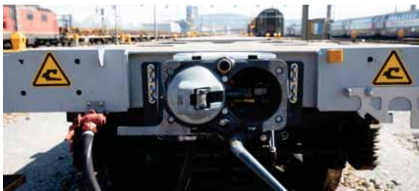
Automatische Kupplung: Diese Komponente wird momentan am „5L“-Demonstratorzug getestet. Sie wird den Rangierbetrieb deutlich effizienter gestalten.
