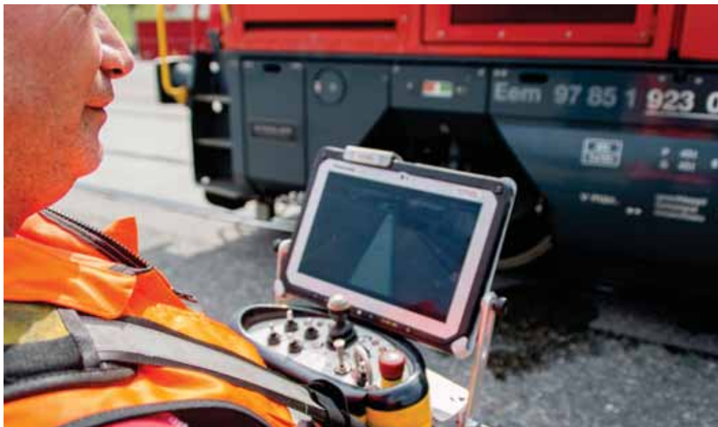
Kollisionswarnsystem: Sensoren und Kameras erfassen beim Rangieren den Raum vor der Lok und warnen akustisch und visuell vor Hindernissen. Der Rangiermitarbeiter steht dabei neben dem Zug und steuert ihn mit der Funkfernsteuerung und dem Kollisionswarnsystem.
