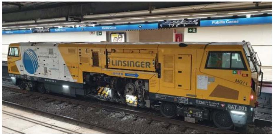
Abb. 3: Schienenfräsen in der Metro mittels MG11
