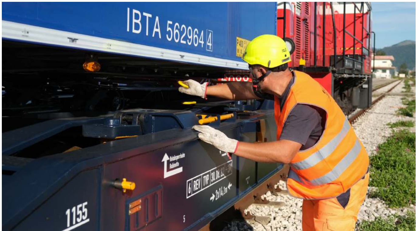
La surveillance en temps réel du chevalet de support pi permet de détecter de manière fiable le bon réglage et le bon verrouillage pendant le transport de la remorque dans le secteur intermodal. Crédit : Polo Logistica FS, utilisation gratuite
