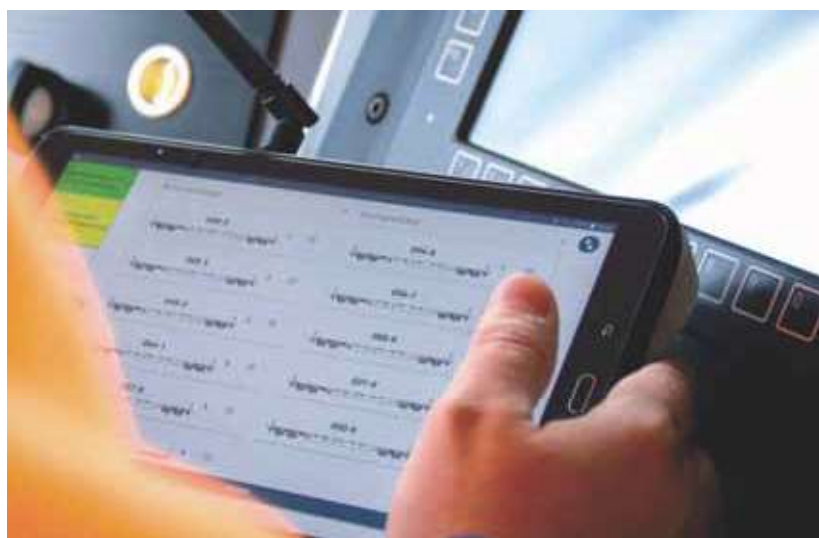
Die von PJM entwickelte automatische Bremsprobe ermöglicht eine Zeitersparnis von rund 20 Minuten.
