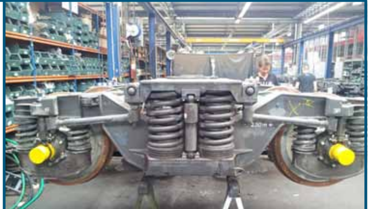
Abb.: Eingebauter Messradsatz bei Testfahrten
