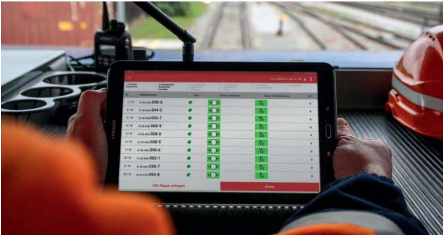
Abb. 3: Die Ergebnisse der automatisiert durchgeführten Bremsprobe sind übersichtlich am Display des Bremsprobeverantwortlichen / Triebfahrzeugführers dargestellt. Quelle: SBB Cargo
