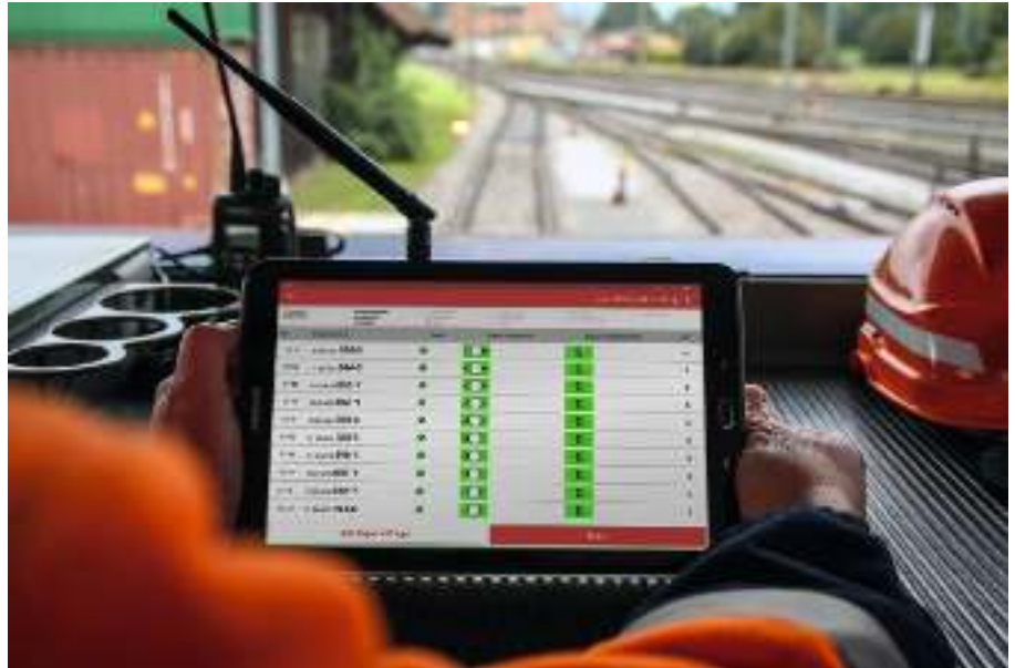
4: Die Daten aus Sensorik und Funksystem werden in der Bremsproben-App übersichtlich auf dem Tablet dargestellt Foto: SBB Cargo
