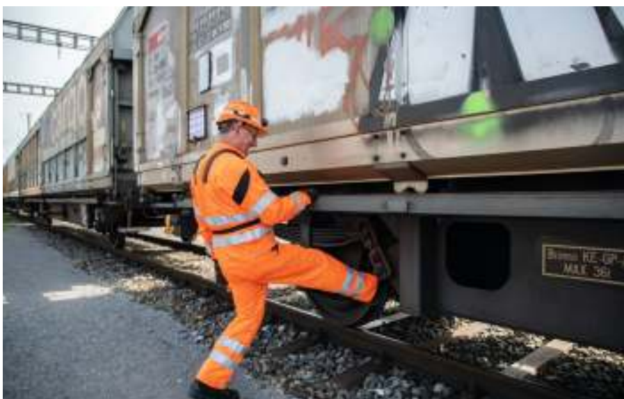
1: Die manuelle Überprüfung der Bremsen ist körperlich fordernd, anstrengend und zeitintensiv Foto: SBB Cargo
