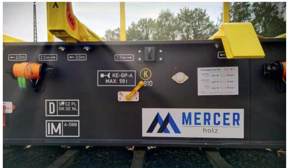
Abb. 2: Vor-Ort-Signalisierung informiert über den Beladezustand während des Ladevorgangs.
