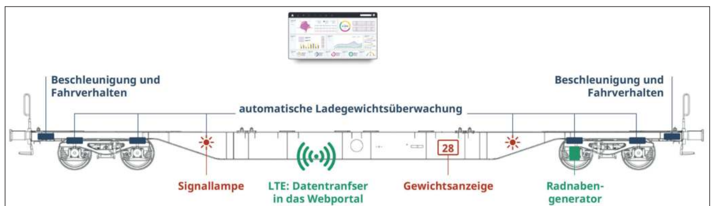
Abb. 1: Konzept der automatischen Ladegewichtsüberwachung
