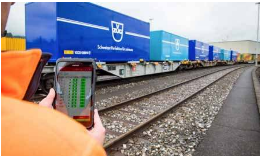
Dank Automatisierung ist ein ordnungsgemäß durchgeführter Bremsencheck bei einem 500 m langen Güterzug in fünf Minuten erledigt.
