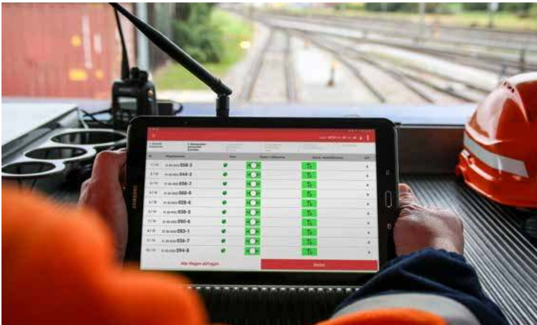
Mit der automatischen Bremsprobe erhält der Lokführer innerhalb weniger Minuten eine zuverlässige Information darüber, ob sein Zug tatsächlich startklar ist.
