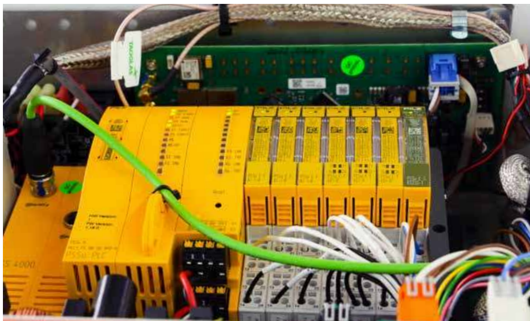
Für Bahn- anwendungen gibt es die Kopfmole des Automatisierungs- systems PSS 4000 auch mit M12- Schnittstelle.
