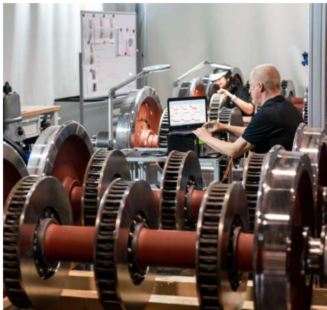
6 Messradsätze wurden am Grazer PJM Standort entwickelt und gefertigt. Die Messtechnik wurde im ÖBB Werk in Wien auf das Testfahrzeug installiert.
